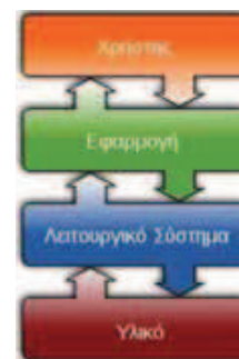
Εικόνα 38 Το Λειτουργικό Σύστημα μεσολαβεί μεταξύ εφαρμογών και υλικού
