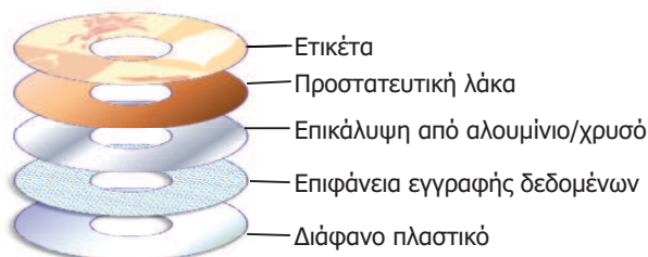
Εικόνα 29 Δομή ενός Οπτικού δίσκου
