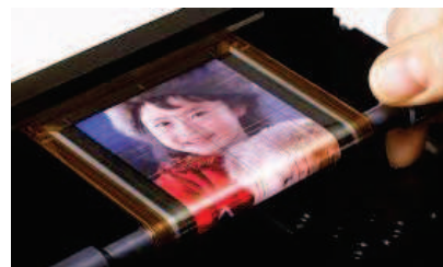
Εικόνα 52 Μια ευλύγιστη οθόνη OLED
