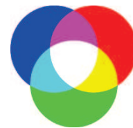
Εικόνα 47 Σύνθεση χρωμάτων με συνδυασμό κόκκινου, πράσινου και μπλε φωτός
