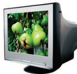
Εικόνα 48 Μια οθόνη καθοδικού σωλήνα
