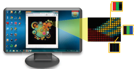
Εικόνα 46 Μια οθόνη αποτελείται από εικονοστοιχεία, το καθένα από αυτά έχει τρεις φωτεινές πηγές, για κόκκινο, πράσινο και μπλε χρώμα
